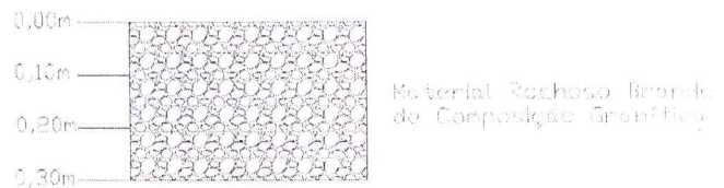
Figura 03 Perfil Esquemático em S03 na Margem Direita com Afloramento de Rocha
