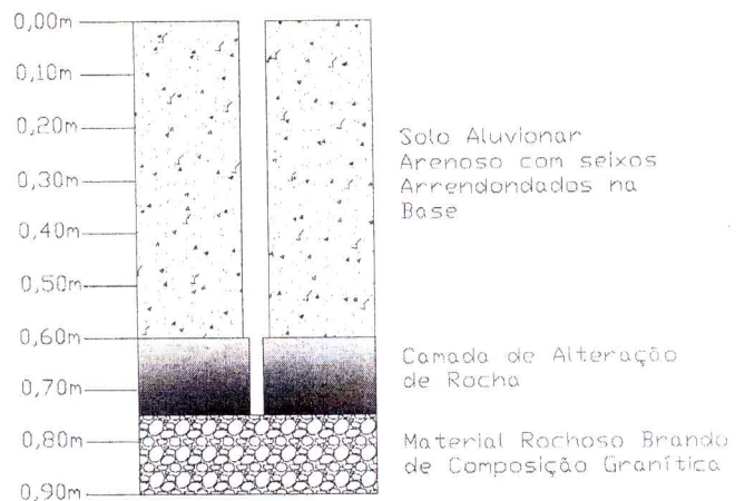
Figura 02 Perfil Esquemático em S02 no Eixo com Profundidade de 0,75m
